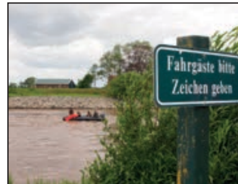
Die Fähre im Einsatz – gezogen per Hand entlang des Stahlseils.
